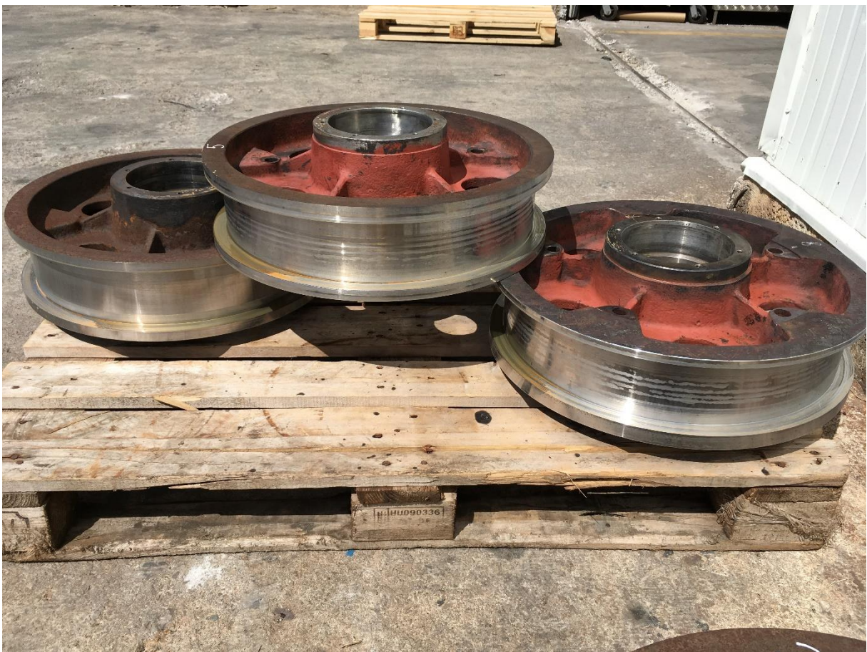
Sanacija istrošenja kotača dizalica, transportnih kolica, strojeva i radne opreme
